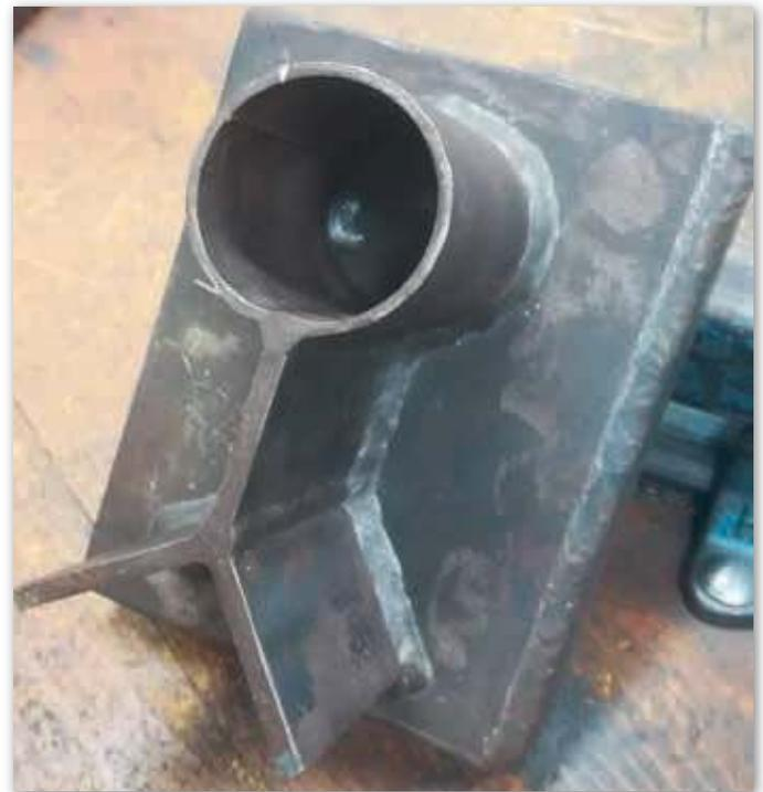
Schweißer sind, konnten wir uns den einen oder anderen nützlichen Tipp bei ihnen anschauen. Zum Abschluss fertigte jeder ein eigenes Prüfstück an, eine Konstruktion, bei der jede Schweißposition vorkommt. Diese wurden anschließend von den kritischen Augen der Lehrer begutachtet.
